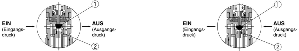
Ist der Eingangsdruck höher als der Ausgangsdruck, arbeitet der Regler normal Regler (Abb. 1).
